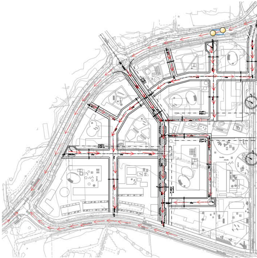
Figur 21. Sekundära avrinningsvägar utifrån förprojektering av lokalgator, Gredebyleden och Knivstaleden
