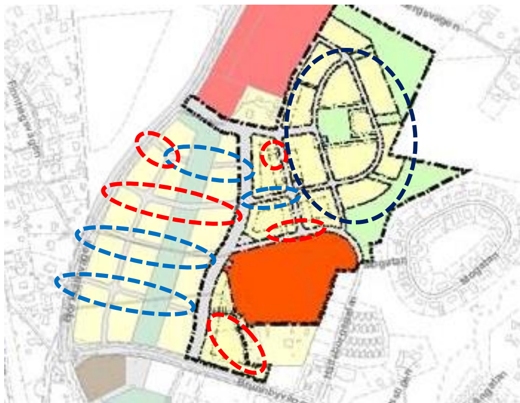
Figur 2.13. Blå kvartersgator föreslås regleras som gågator, bl.a. för att minska risk för smittrafik liksom för att minska korsande bilrörelser inom området. Röda föreslås regleras som gångfartsområde. Svart område föreslås utformas som kvartersgator.
