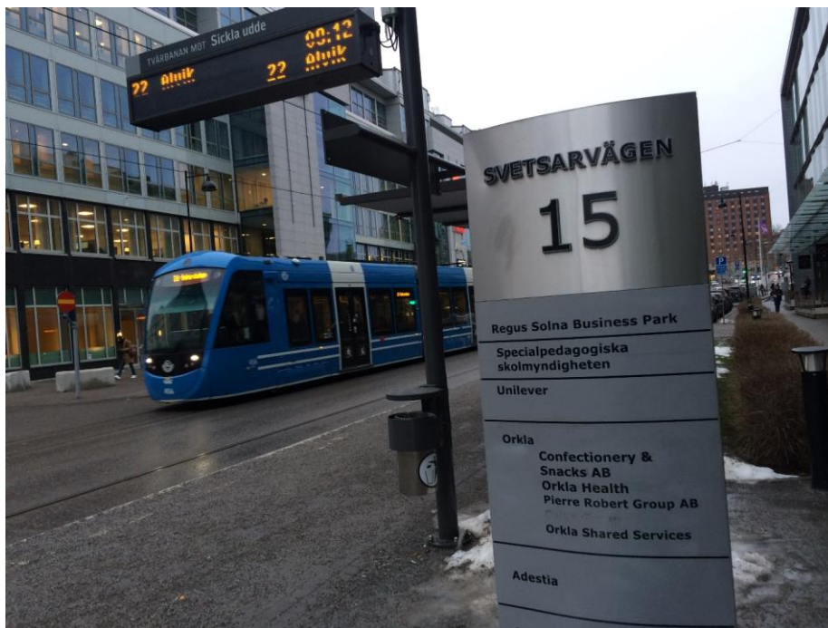
Figur 2.16. Svetsarvägen i Solna har ett gaturum på ungefär 28 meter fasad till fasad. Här går Tvärbanan med två spår. Det finns kantstensparkering på ena sidan gatan, mycket breda trottoarytor men ej cykelbana. Foto: Trafikutredningsbyrån
